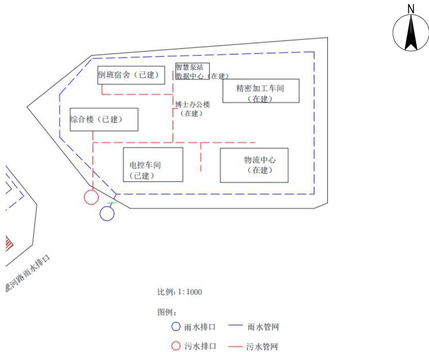
附图 3 三期厂区平面布局及雨污管网图
